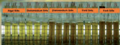
Fig. 1 – Cultivo de Thalassiosira weissflogii en régimen semi-continuo en FBRs de vidrio con 80 ml de volumen con una tasa de renovación diaria del 25% del volumen total.
