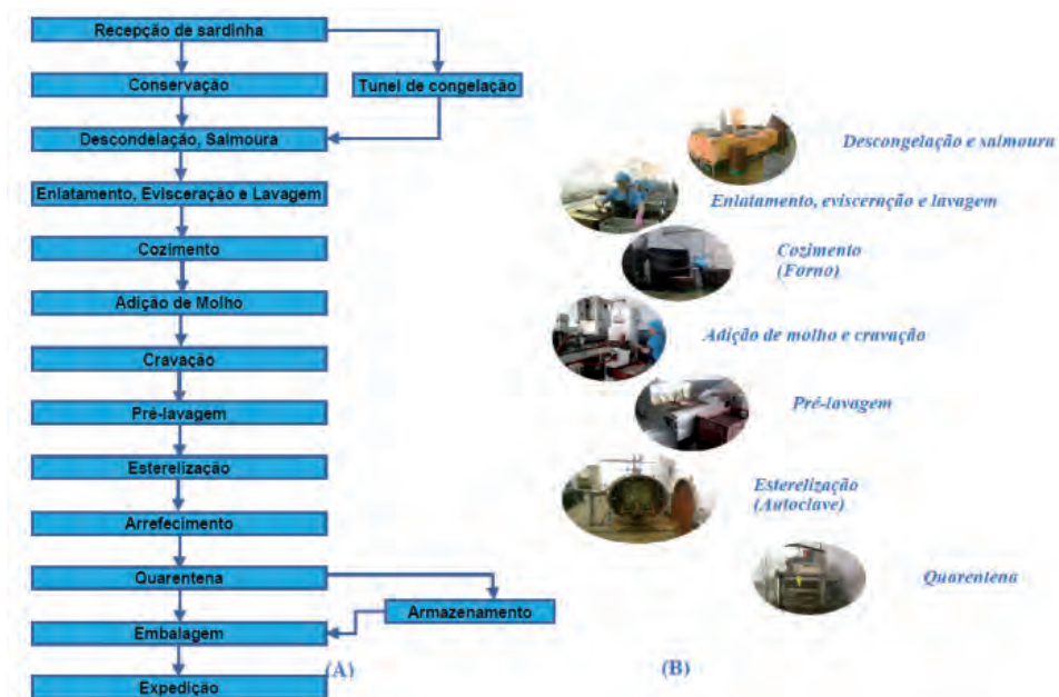
Figura 1.- Fluxo do processo produtivo da sardinha enlatada: (A) – Fluxograma do processo produtivo; (B) – Pontos assinalados
