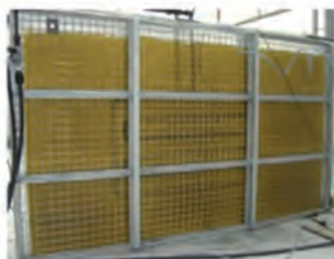
Imagen 2. Sistema de Bolsa plana. Bolsa de polietileno de 200 L y 5 cm de paso de luz
