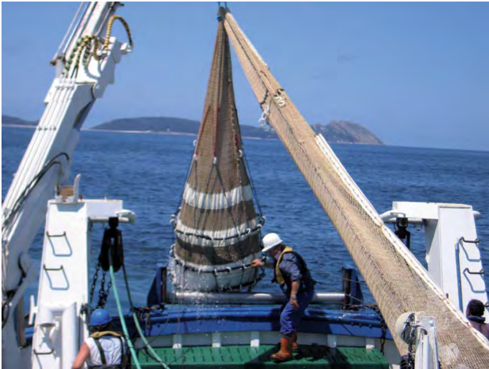
Figura 4.- Red de arrastre diseñada para mantener agua en el interior del copo.
